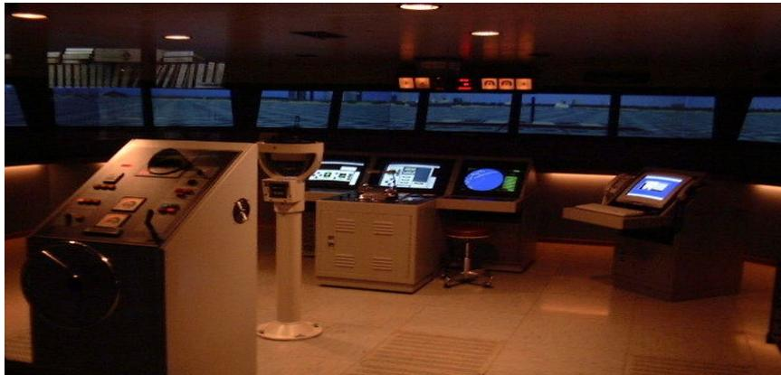
圖 6 操船模擬機 SA PILOTSHIP 2000
