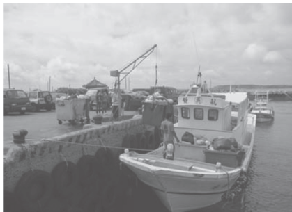
(c) 利用起重機將垃圾子車吊至碼頭
