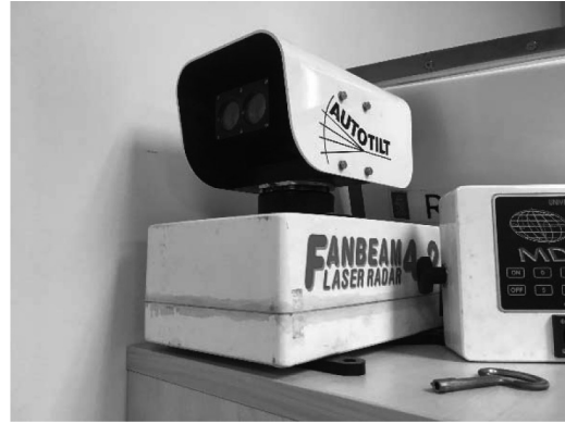
圖 16 Fanbeam 掃測元件
