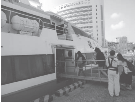
(a) 凱旋 3 號旅客上下船的斜坡板
