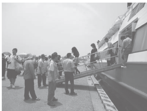
(a) 搭乘凱旋 3 號至馬公港，因水位漲高，斜坡板陡峭，輪椅通行不便
